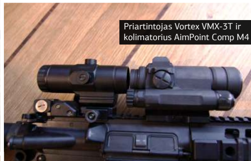
Priklausomai nuo būtinumo priartintojas vienu judesiu lengvai „numetamas“ į šoną ir galima šaudyti naudojant tik kolimatorių
